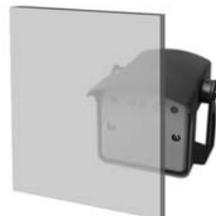
Ne pas placer le détecteur directement derrière un panneau ou un matériau quelconque.
