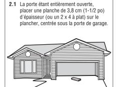
2.2 Appuyer sur le bouton-poussoir de la télécommande pour fermer la porte. La porte DOIT remonter quand elle entre en contact avec la planche.
