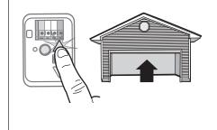
1.7 Appuyer et relâcher le bouton DOWN. La porte se déplacera jusqu'à la position de fermeture programmée. La programmation est terminée.
