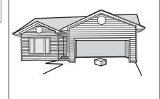
3.2 Appuyer sur le bouton-poussoir de la télécommande pour fermer la porte. La porte ne se déplacera pas plus de 2,5 cm (1 po) et l'éclairage de l'ouvre-porte de garage clignotera 10 fois.
