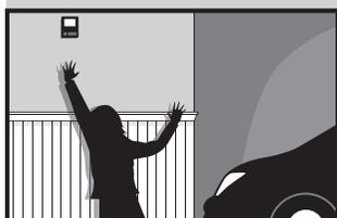
**Le bouton-poussoir monté au mur doit être hors de portée des enfants** à au moins 1,5 m (5 pi) de la surface d'appui la plus proche et à l'écart de toutes les pièces mobiles. Montez et utilisez le bouton là où vous pouvez clairement voir la porte de garage qui se ferme.
