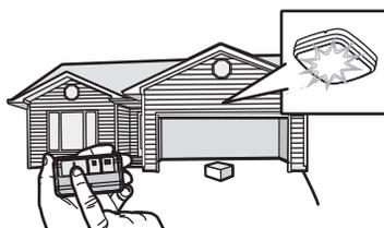
L'ouvre-porte de garage ne se fermera pas à l'aide d'une télécommande si le témoin DEL d'un des deux capteurs d'inversion est éteint (ce qui avertit que le détecteur est mal aligné ou obstrué).
