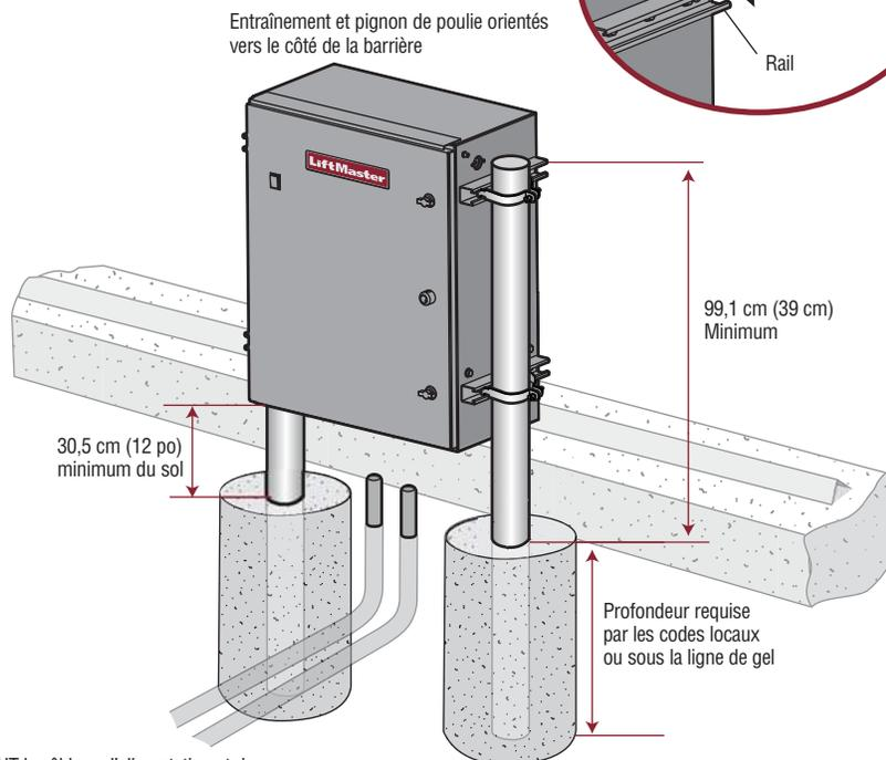
TOUT le câblage d'alimentation et de commande doit être acheminé dans un conduit séparé
